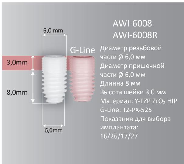
*Система одноэтапных AWI имплантантов предлагается различной длины и диаметра.*
